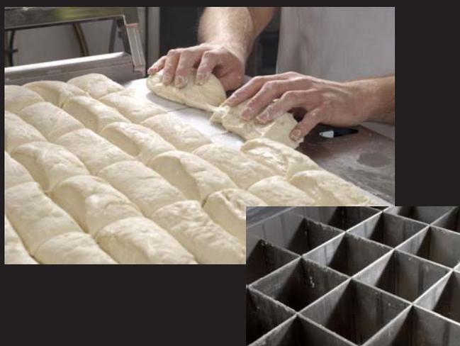
La diviseuse hydraulique Divimach est une machine automatique **destinée à diviser en pâtons égaux une pâte préalablement pesée.**
